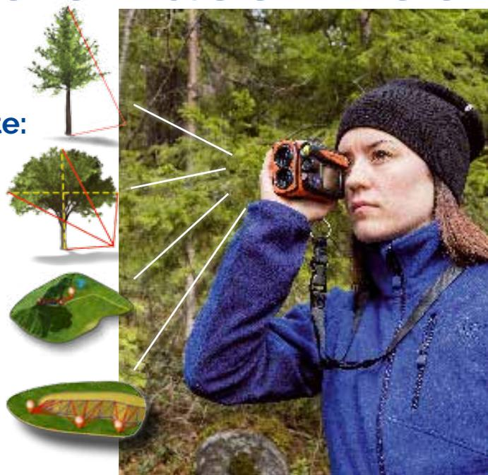
GPS e funzione bussola incorporata nello strumento con precisione fino a <1,5 gradi RSME (errore radice quadratica media) con HUD per l'aggiornamento della misurazione in tempo reale.
